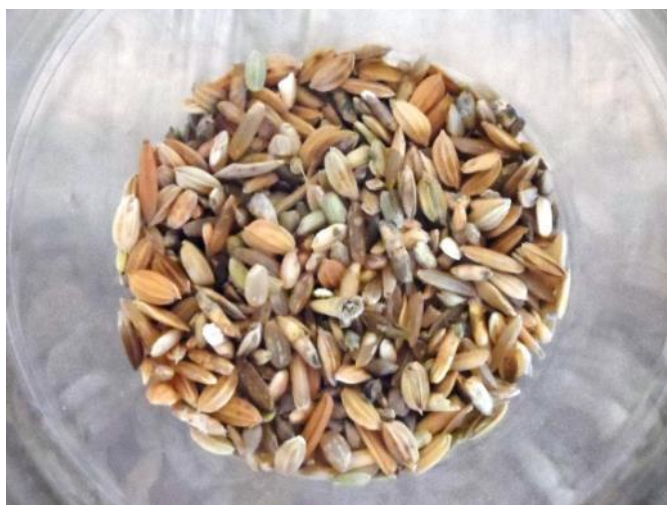
Brisures de riz, grains de riz complet, riz paddy, graines d'adventices, ... présents dans la balle de riz non nettoyée
