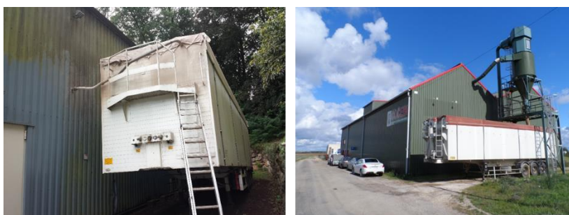
Stockage dans des bennes « fond mouvant » de 90 m 3
