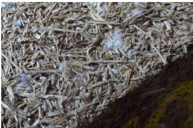
Photo Pierre Delot. Conditions hivernales. Traces de moisissures sur un brique chaux-balle de riz brute-paille de riz broyée (dosage en masse : 1/0.9/0.1)
